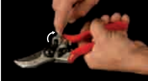
14. Colocar correctamente el muelle
