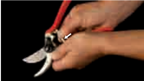
14. Colocar correctamente el muelle
